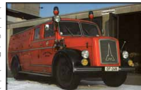
TLF 15 auf Magirus-Deutz-S-3500-Chassis mit luftgeköhlter 90 PS Maschine von 1954.
